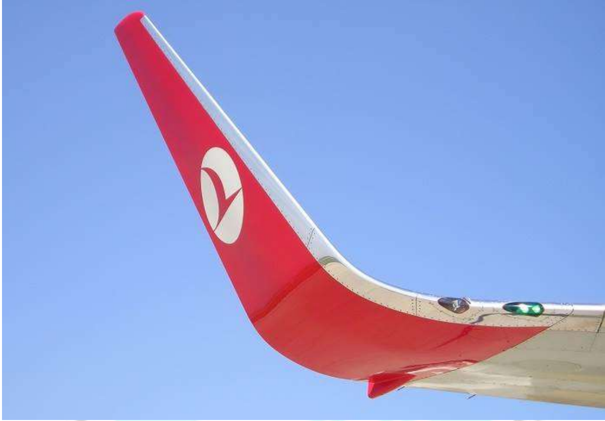
Şekil 1. Yolcu Uçağı Kanat Ucunda Bulunan Örnek Bir Winglet Yapısı[1]
