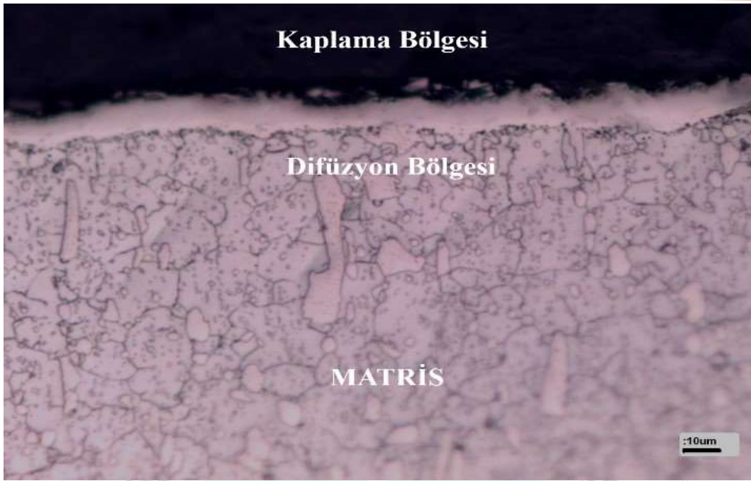
Görsel 1. AISI D2 çeliğinin CrC kaplama işlemi sonucunda oluşan a)5x büyütme b)10x büyütme ve c)20x büyütmede optik mikro yapı görüntüleri
