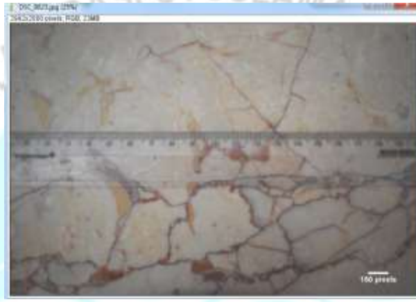
Görsel 5 ImageJ programına yüklenen mermer plaka örneğinin ölçekli görünümü
