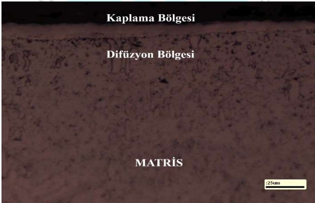
Görsel 1. AISI D2 çeliğinin nitrasyon kaplama işlemi sonucunda oluşan a)5x büyütme b)10x büyütme ve c)20x büyütmede optik mikro yapı görüntüleri
