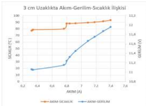
Görsel 3. Fanın ısıtıcıya olan pozisyonuna göre elde edilen sıcaklıklar
