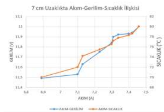
Görsel 3. Fanın ısıtıcıya olan pozisyonuna göre elde edilen sıcaklıklar
