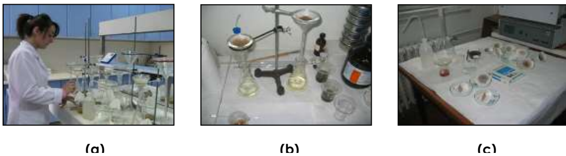
Şekil 5. Gazi Üniversitesi Malzeme Araştırma ve Koruma Laboratuvarı (MAKLAB) asidik agrega & bağlayıcı analizi: (a) Asidik işlem (%5 HCl), (b) Süzme ve yıkama, (c) Kurutma
