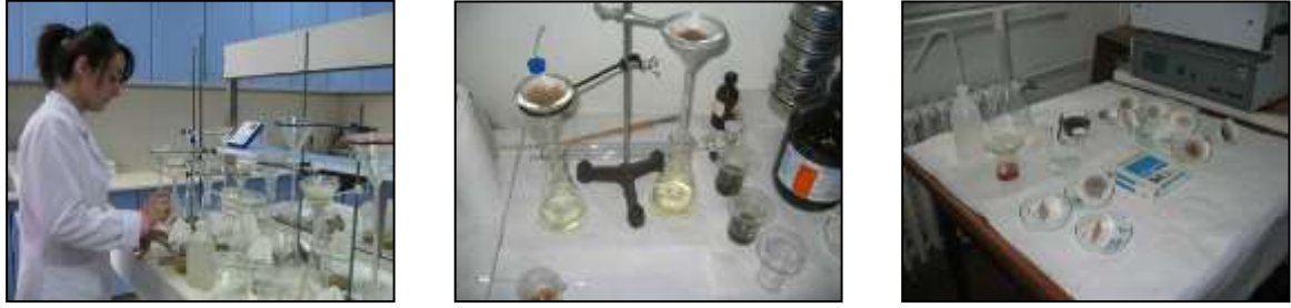
Şekil 3. Tarihi Malzeme Araştırma ve Koruma Laboratuvarı (MAKLAB) asidik agrega & bağlayıcı analizi: (a) Asidik işlem (%5 HCl), (b) Süzme ve yıkama ve (c) Kurutma
