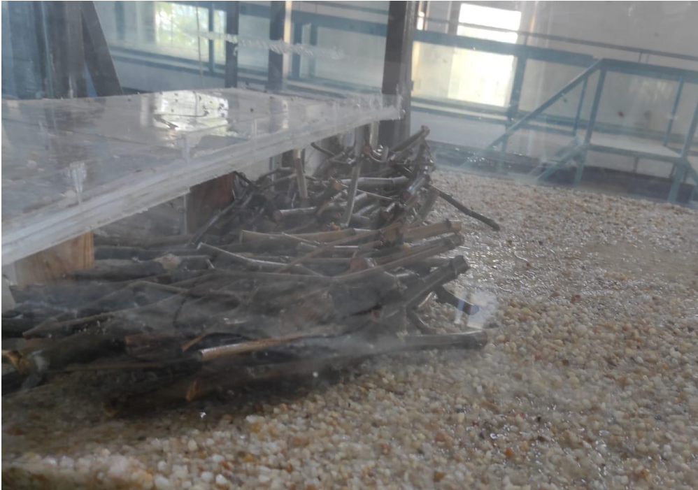
Görsel 3. Bloksuz köprüde odun birikmesi yandan bakışı
