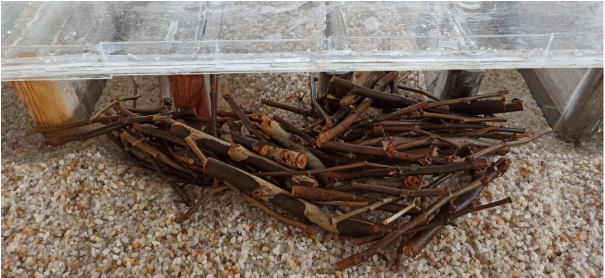
Görsel 6. Bloklu köprüde ani gelen odun malzemelerin köprü ayağında birikmesi
