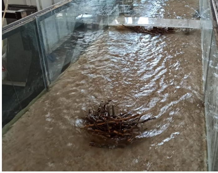
Görsel 7. Bloklü köprüde tedrici gelen odun malzemelerin blokta birikmiş hali
