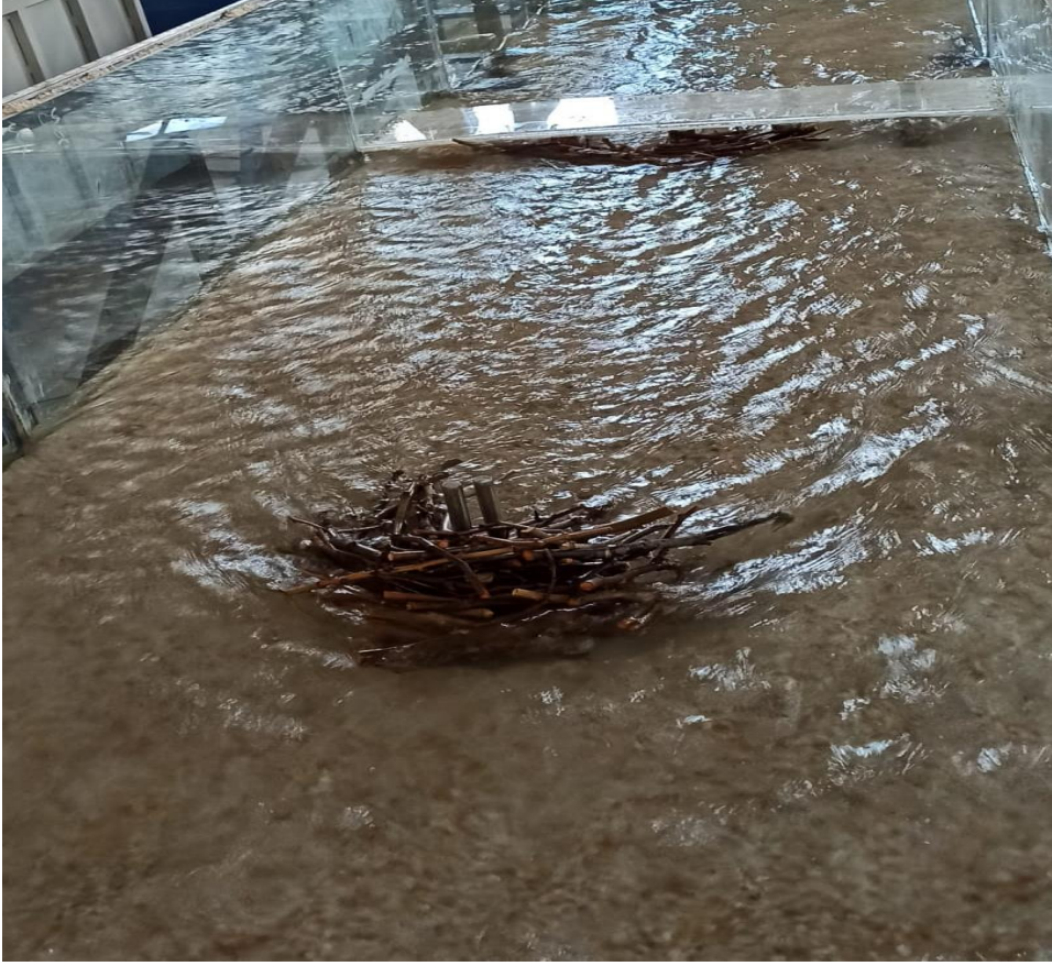
Görsel 5. Bloklu köprüde ani gelen odun malzemelerin blokta birikmiş hali
