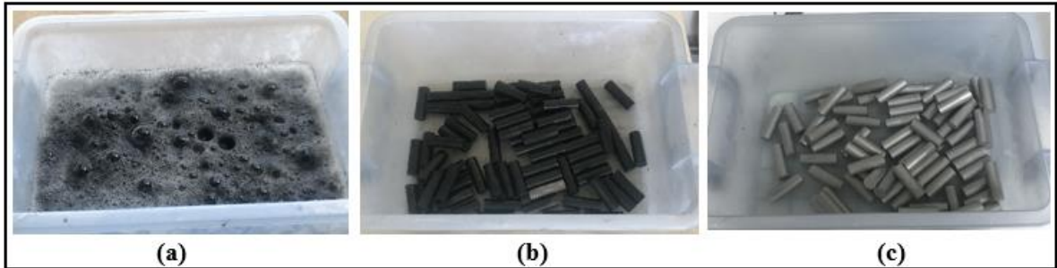
Görsel 1: Alüminyum parçalara uygulanan kimyasal yüzey ön işlemleri, a) NaOH çözeltisi ile oksit tabakasını çıkarılması, b) oksit tabakasının çıkarılma sonrası alüminyum parçalar, c) kalıntı NaOH çözeltisi giderilmiş alüminyum parçalar.
