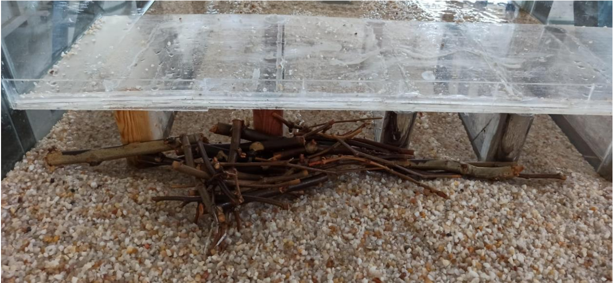
Görsel 8. Bloklü köprüde tedrici gelen odun malzemelerin köprü ayağında birikmesi
