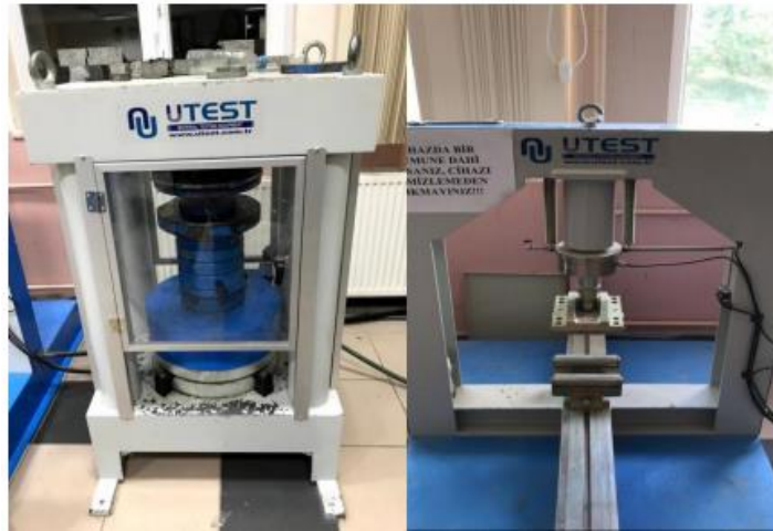
Görsel 1. Basınç dayanımı deney cihazı (a) ve eğilme mukavemeti deney cihazı (b)
